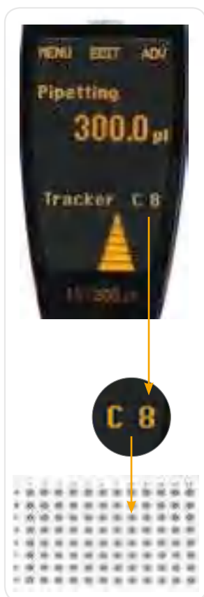
Функция отслеживания заполнения микропланшета в действии
