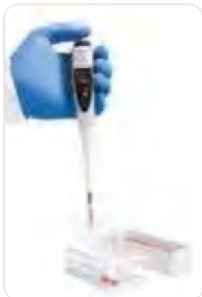
В процессе набора жидкости держите дозатор в вертикальном положении.
