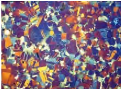
Слева: Светлое поле, 200x. Справа: при прохождении через широкополосные синие/узкополосные оранжевые фильтры, 200x
