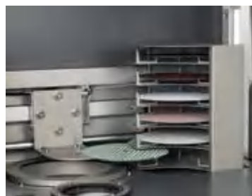
Шаг 3: ...и перемещает MD-расходный материал на подъемник
