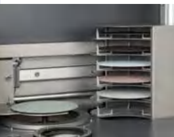
Шаг 1: Центральная часть пробоподготовительного диска поднимается для смены MD-расходных материалов
