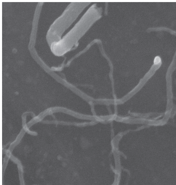
Наполная модель с W Многослойные углеродные нанотрубки 10 kV SE @ 100.000x
