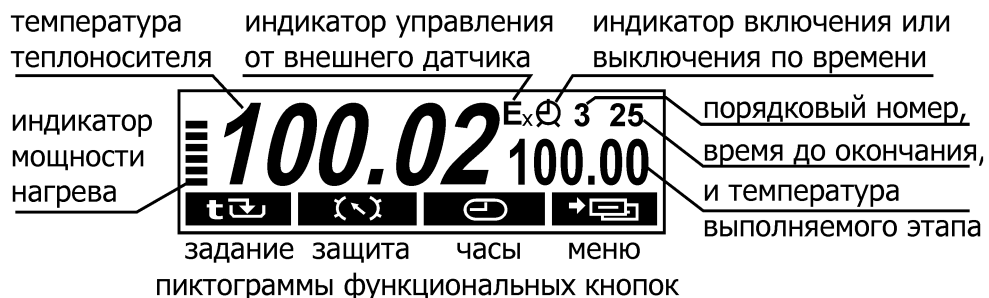
Рисунок 5 — Дисплей в режиме регулирования по программе
