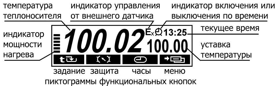
Рисунок 4 — Дисплей в режиме регулирования по уставке
