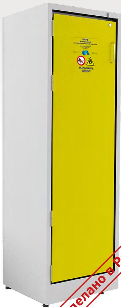
**В**нешний корпус шкафа полностью изготовлен из травленой и гальванизированной листовой стали, окрашенной эпоксидной кислотостойкой краской, нанесенной путем электростатического напыления и последующей полимеризацией в печи при температуре 200° С. Толщина покрытия проверяется сертифицированными измерительными приборами.
