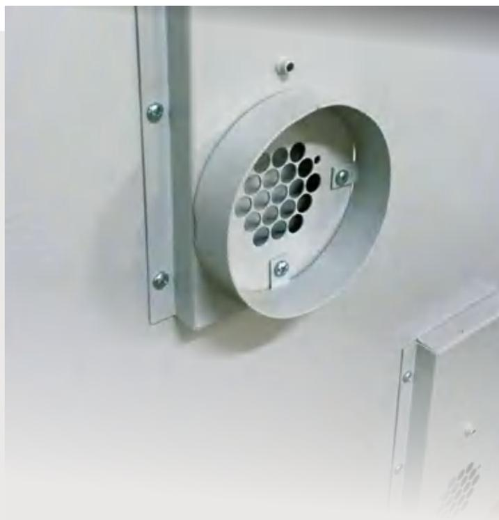
**Система внутренней не форсированной вентиляции** для паров, укомплектованная двумя предохранительными клапанами с автоматическим закрытием при температуре окружающей среды  $+70 \pm 10^\circ \text{C}$ , находящимися внизу и вверху, чтобы гарантировать автоматический выход наружу веществ, в соответствии с требованиями. Наружный соединительный фланец для подключения к системе вытяжной вентиляции, диаметром 100 мм.
