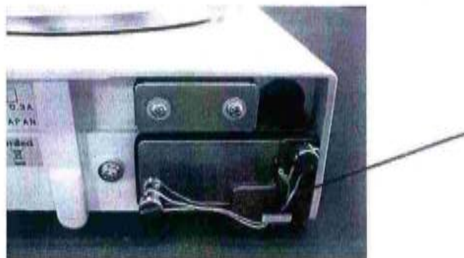
Рисунок 2 – Схема пломбировки весов
