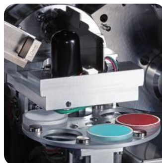
Шестипозиционное устройство смены образцов
