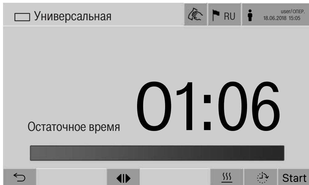
В верхней строке отображается пиктограмма загрузочного устройства и выбранная программа обработки.
