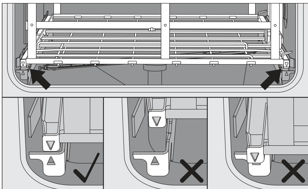
Отметки на загрузочном устройстве **▼** и в моечной камере **▲** должны совпадать, т. е. быть на одном уровне.
