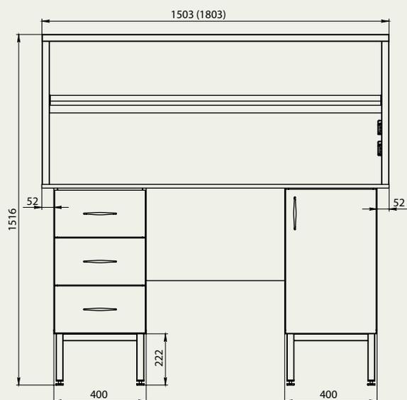
В основе пристенного физического стола **1200 ПФ (□)** — лабораторный высокий стол **СОВЛАБ-1200 СЛ (□) в.** На него установлена рабочая поверхность размером 1200x800 мм. На столешницу установлен технологический стеллаж.
