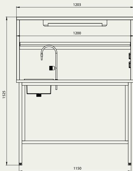
Пристенный ХИМИЧЕСКИЙ СТОЛ отличается от ФИЗИЧЕСКОГО — наличием подвода воды. В базовую комплектацию входит: Сливная раковина из полипропилена 150x300 мм. (сифон и гофрированная труба в комплекте), химически стойкий моно-смеситель для подвода холодной воды.
