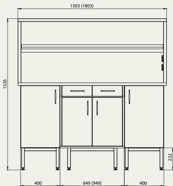
В основе пристенного физического стола **1200 ПФ ( )Т** — Опорная тумба на металлическом каркасе. На него установлена рабочая поверхность размером 1200x800 мм. На столешницу установлен технологический стеллаж.
