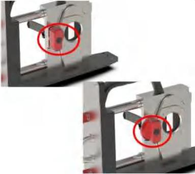
3. Сложите фиксирующую пластину и снимите ее.
