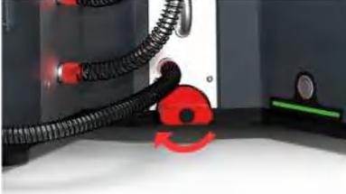
2. Потяните измерительную ячейку к передней части выдвижного ящика измерительного блока.
