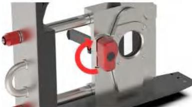
3. Зажмите измерительную ячейку для измерения в жидкости с помощью защелки с противоположной стороны.
