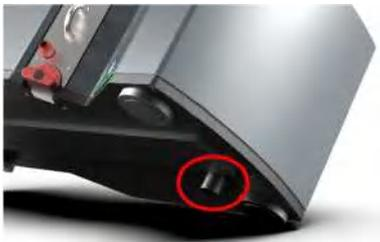
При каждой транспортировке измерительного блока необходимо вкручивать транспортное крепежное устройство. Установите основной детектор в предназначенном положении. (Смотрите руководство MaScontrol)
