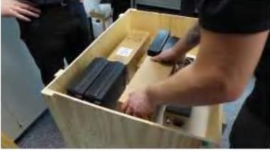
4. Затем извлеките ванну для образцов, блок ультразвука (если он заказан), два футляра для дополнительного оборудования и картонную коробку со шлангами.
