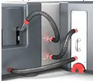
4. Подсоедините шланги, как показано на изображении, к блоку диспергирования в жидкости и к блоку ультразвука (опционально). С левой стороны показано соединение шланга без блока ультразвука; напрямую с блоком ультразвука. Шланги подсоединяются к измерительной ячейке стандартным методом. См. Главу 9.1 «Замена шлангов в блоке диспергирования в жидкости» на стр. 45.
