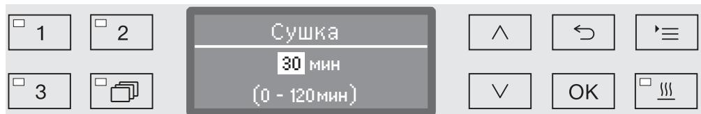
Если было установлено изменяемое время, на дисплее отображается время сушки в минутах (мин), предварительно установленное для данной программы, и в нижней строке дисплея приводится возможный диапазон установок.
