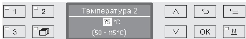
Температура устанавливается с шагом в 5 °C. В самой нижней строке приводится диапазон возможных установок.
