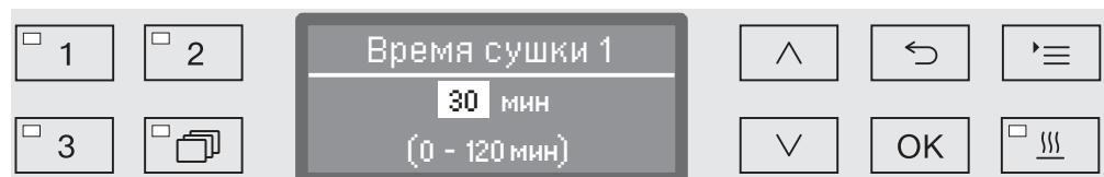
Время выдержки устанавливается с шагом в 1 минуту. В самой нижней строке приводится диапазон возможных установок.
