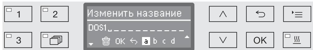
В средней строке отображается текущее название. Его можно будет обработать с помощью опций из нижней строки. В верхней строке отображается выбранная опция из нижней строки.
