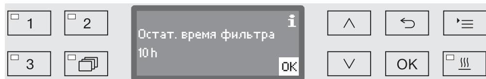
После обнуления счетчика на дисплее появляется индикация остающихся часов работы для данного типа фильтра.
