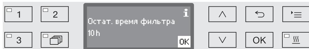
После обнуления счетчика на дисплее появляется индикация оставшихся часов работы для данного типа фильтра.
