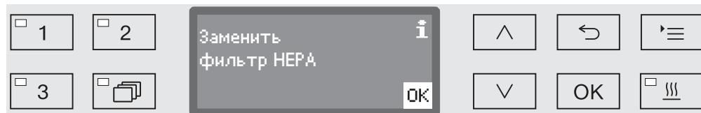
Безаварийная работа возможна только с **оригинальным фильтром Miele класса HEPA 13**.
