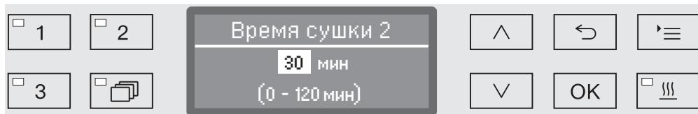
Время выдержки устанавливается с шагом в 1 минуту. В самой нижней строке приводится диапазон возможных установок.
