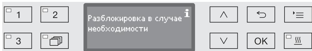
Сообщение остается на дисплее до закрытия дверцы. В выключенном состоянии прибора протокол не составляется.
