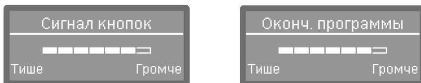
Уровень громкости отображается с помощью сегментной шкалы. При самой низкой установке сигнал зуммера выключен.
